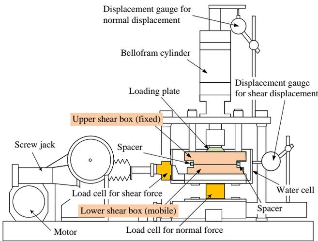
Fig. 5 Box shear test apparatus
