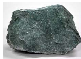
(a)モルデナイトを主成分とする天然ゼオライトの原石
